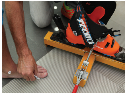
Na noze se vyznačí kritická místa, která se následně - opět bez vnitřní botičky - otisknou ve skeletu.
