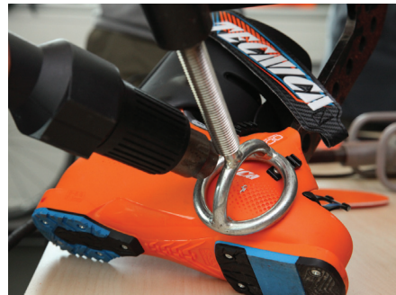
Skelet se pak v kritických místech zahřívá a vytahuje nebo také brousí.
